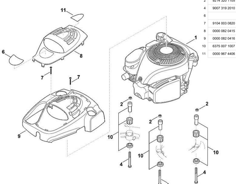
B&S, moteur-quatre-temps 100602-0161-H8, 100602-0161-B8, 100602-2118-B8, 100602-0118-B1 (Lire les données sur le moteur, pour les pièces de rechange, voir la rubrique « Moteurs »)
